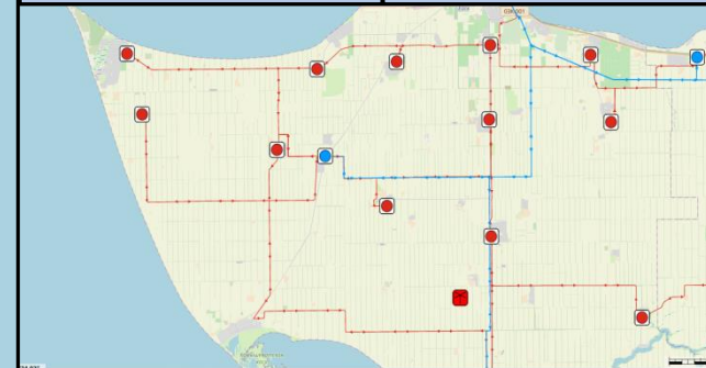
Схема ЛЭП, электростанций и подстанций Ейского района
